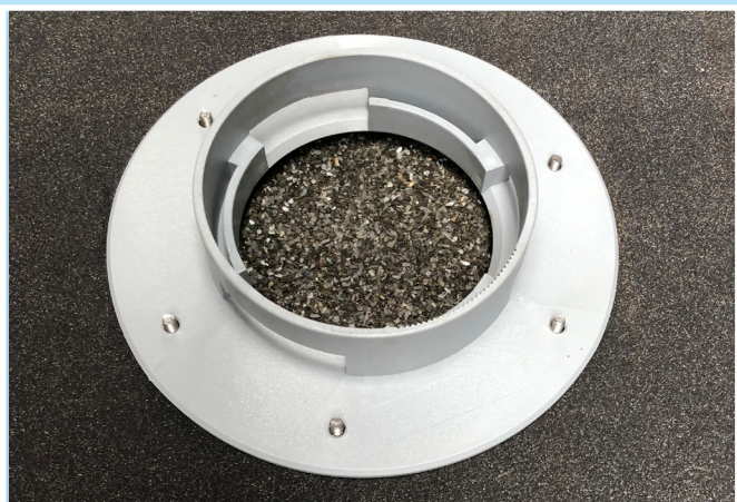
Afbeelding 8. Bovenaanzicht van ring B met bevestiging op de ring A, zonder bevestiging van de moeren
